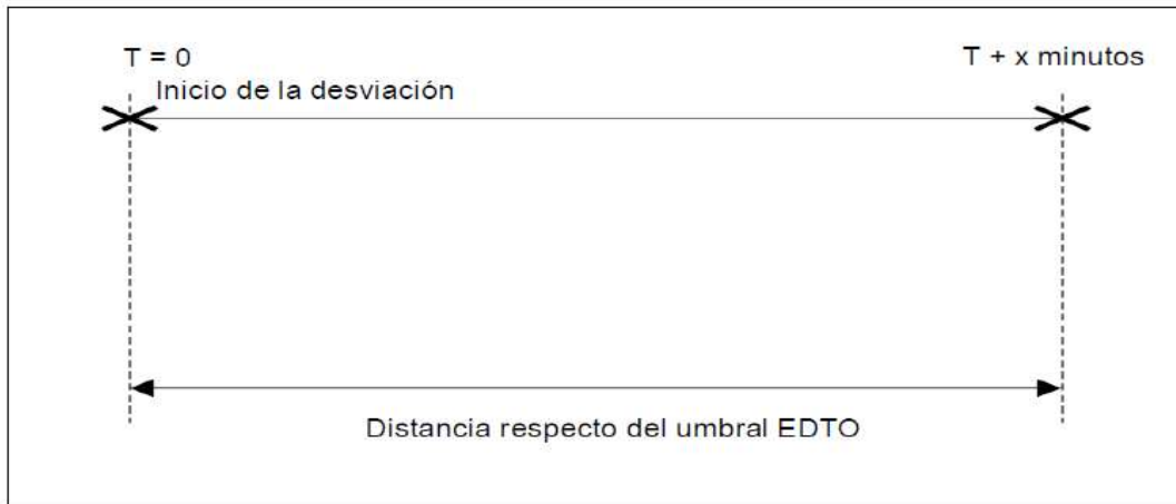
Figura D-5. Distancia respecto del umbral — aviones con más de dos motores de turbina
